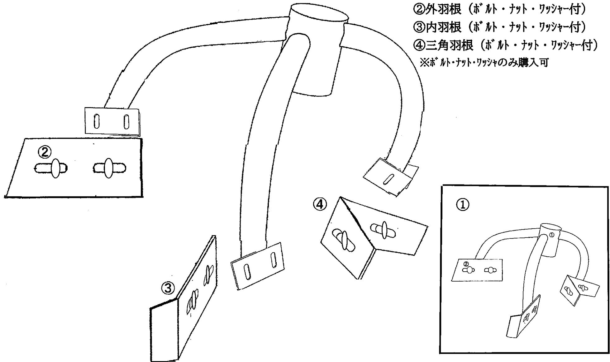
3.5型羽根軸 角底3本軸(完成羽根軸) 分解図
